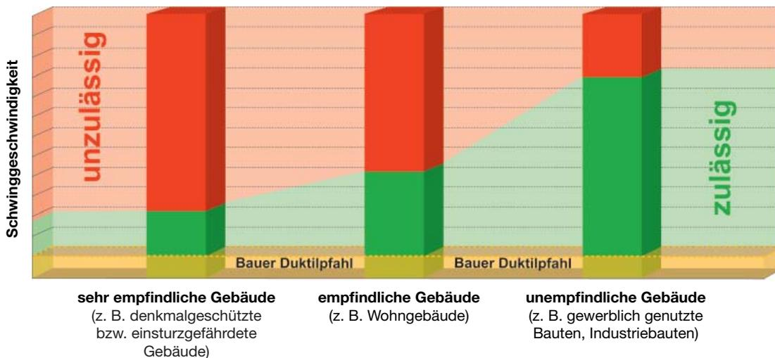
Der Einbau von Bauer DUKI Pfählen ist geräusch- und vibrationsarm. Im Allgemeinen sind die Vibrationen, die während des Einbaus des Bauer Duktilpfahls entstehen, für nahezu jede Art von Gebäude harmlos.
