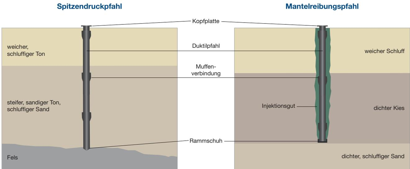
Ein spezieller Verpressschuh ermöglicht es, den Hohlraum zwischen dem Pfahl und dem umgebenden Erd-
