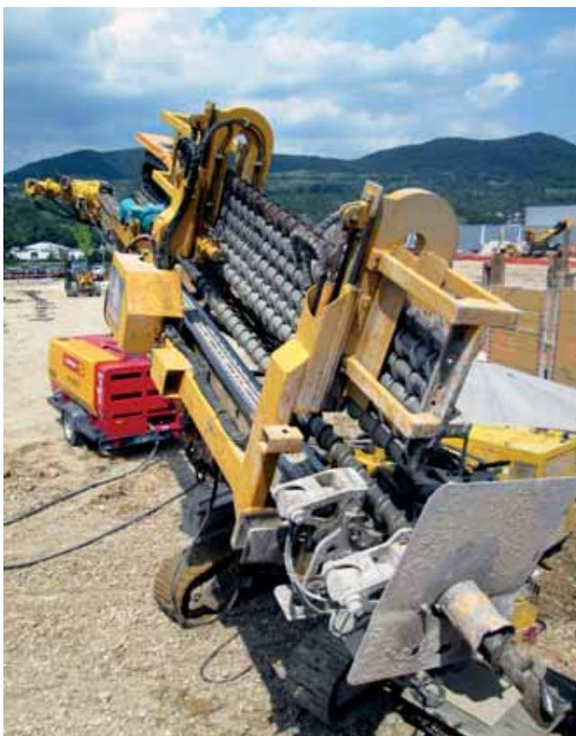
**Beim Schneckenbohrverfahren können Anker unabhängig vom Bohrvorgang eingebaut werden – ein wichtiger Aspekt für den Erfolg der Baustelle.**
