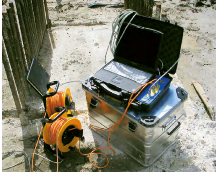
Aufgebautes Cross Hole Ultrasonic Messgerät (CHUM Messeinheit) ( www.Piletest.com )
